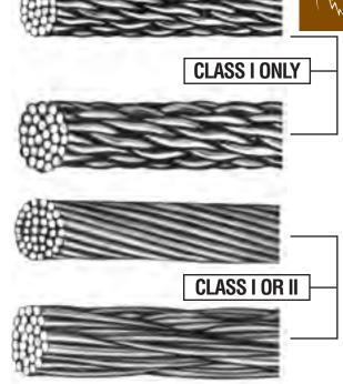
NOTE: ALUMINUM CABLES SHOULD NEVER BE USED UNDER GROUND. THE CONVERSION BETWEEN ALUMINUM AND COPPER SHOULD BE MADE NOT LESS THAN 1½ FEET ABOVE GRADE BY THE USE OF THE BIMETAL CLAMPS SHOWN ON PAGE 22.
